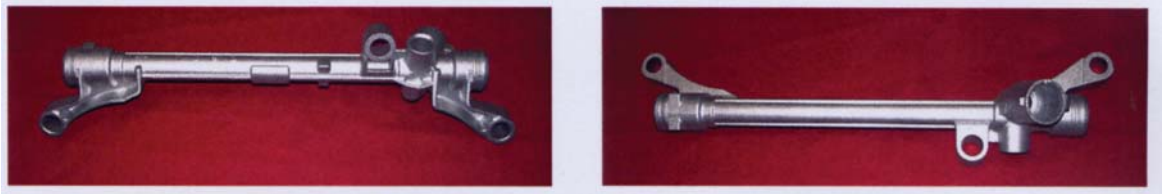
Bild 12. Styrstag. Dimension: 660 mm x 170 mm. Vikt 3 kg.
